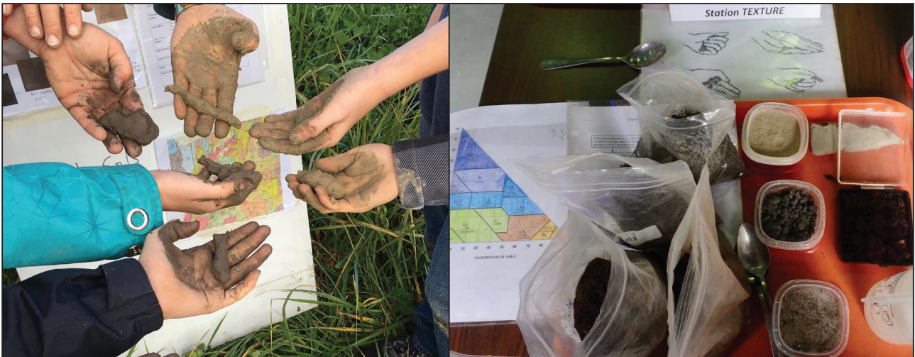
Figure 6 - Évaluation manuelle de textures de sol par la technique du ruban, pour déterminer la proportion d'argile, de limon et de sable. Figure 6 - Manual test of soil texture with the ribbon technic, to determine the proportion of clay, silt and sand.
