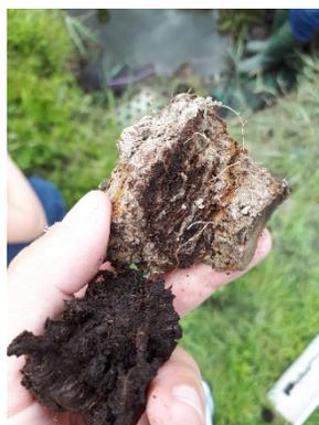
Figure 5: Texture fibreuse du sol et présence de tâches d'oxydation.
